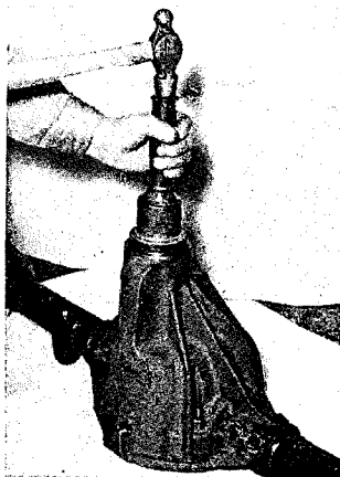
図8-21 外側ベアリング・アウトレース圧入
