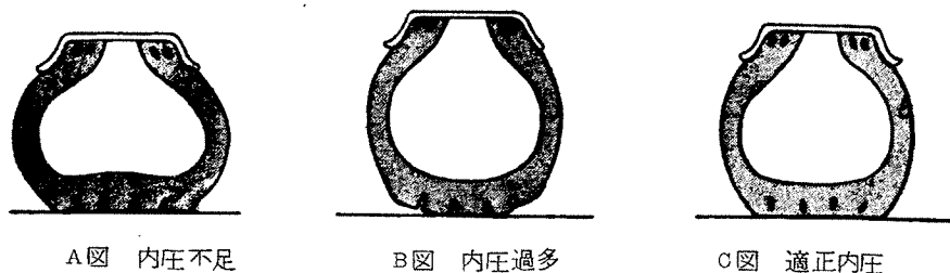
図10-9 タイヤ空気圧によるタイヤ変形
