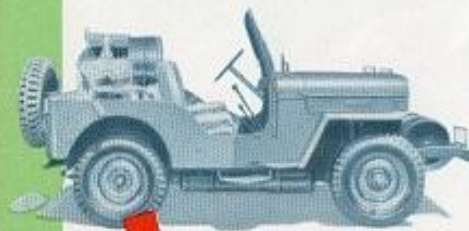
さく岩機を駆動するコンプレッサー車
